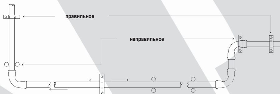
Рис. 6 Правильное закрепление фиксаторов, как опор неподвижных и подвижных.
